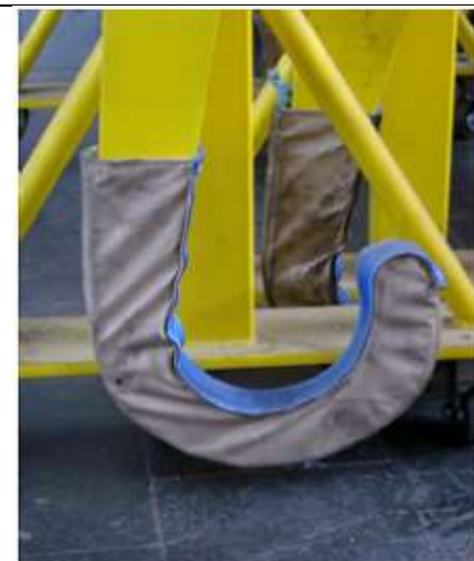
Bild 2: Kranhebestell für Radsätze, Schutz abnehmbar
