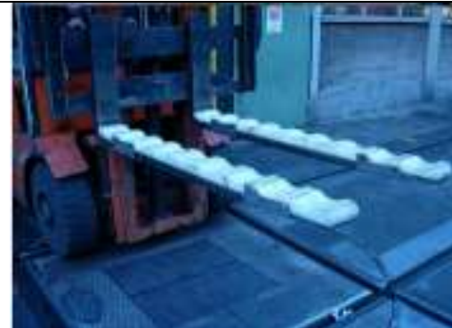
Bild 8: Radsatzaufnahme für Gabelstapler (mehrere Radsätze)
