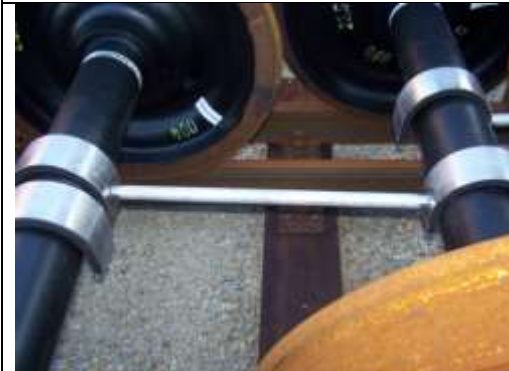
Bild 7: Versetzte Lagerung im Doppelgleis mittels Abstandhaltern
