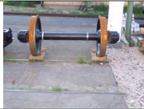
Bild 6: Einzellagerung mittels Ladegestell für Einzelradsätze
