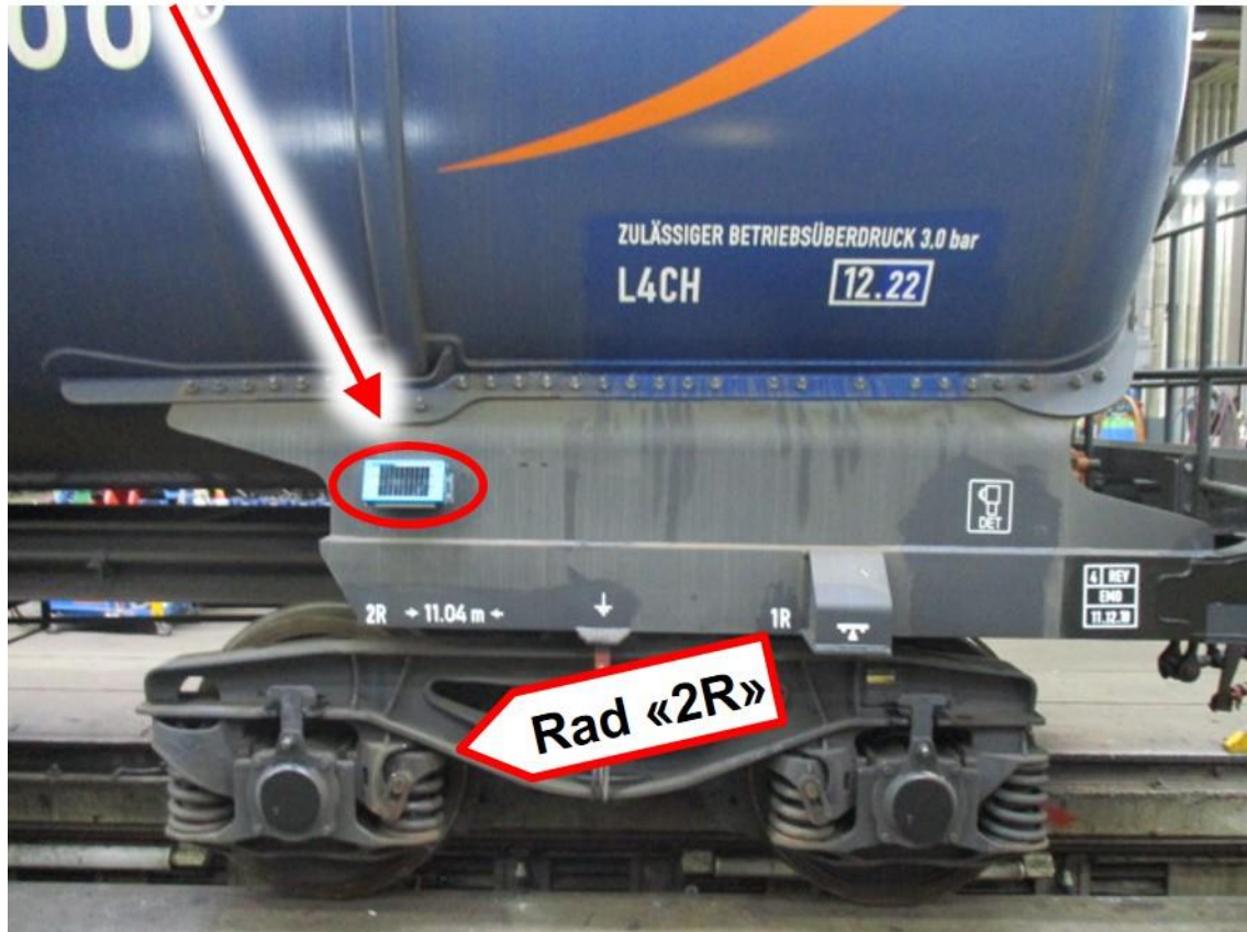
Einbau- / Montageort beim Tanksattel oberhalb Radsatz 2R
